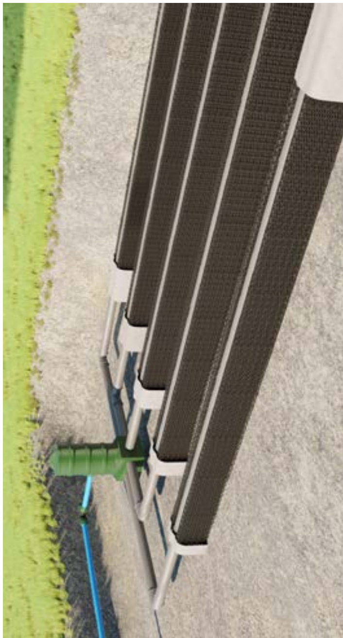
Fot. 4. Przykład drenażu na pakietach rozszczepionych.
