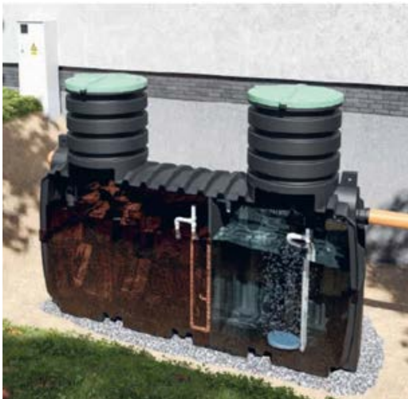
Fot. 9 Przykład biologicznej oczyszczalni SBR (sekwencyjny reaktor biologiczny) z rotacyjnym zbiornikiem dwukomorowym.
